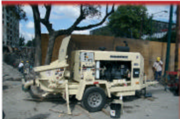
Bombas de concreto estacionarias
